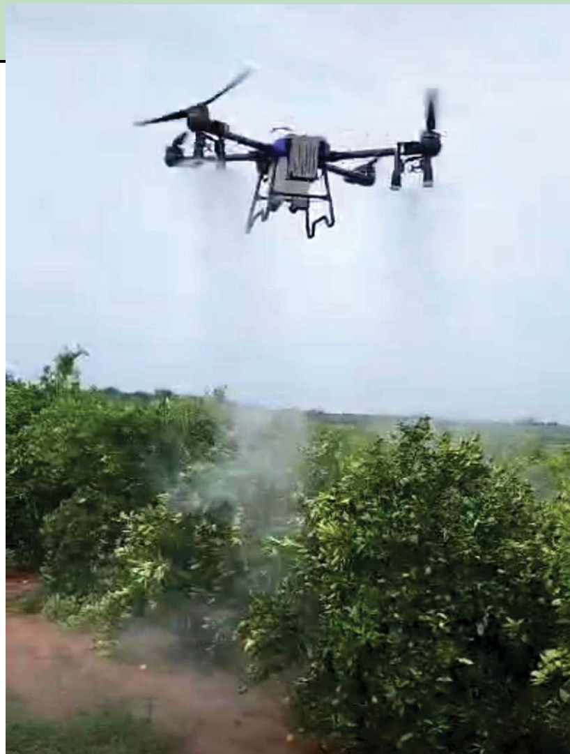
Obrigado, Eng agrônomo GERALDO ANTONIO FEREGUETTI pelo envio da FOTO do DRONE aplicando Óleo de Milho Ozonizado visando o controle de Greening em pomar de Citrus
